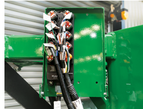
Boom I/O module.
